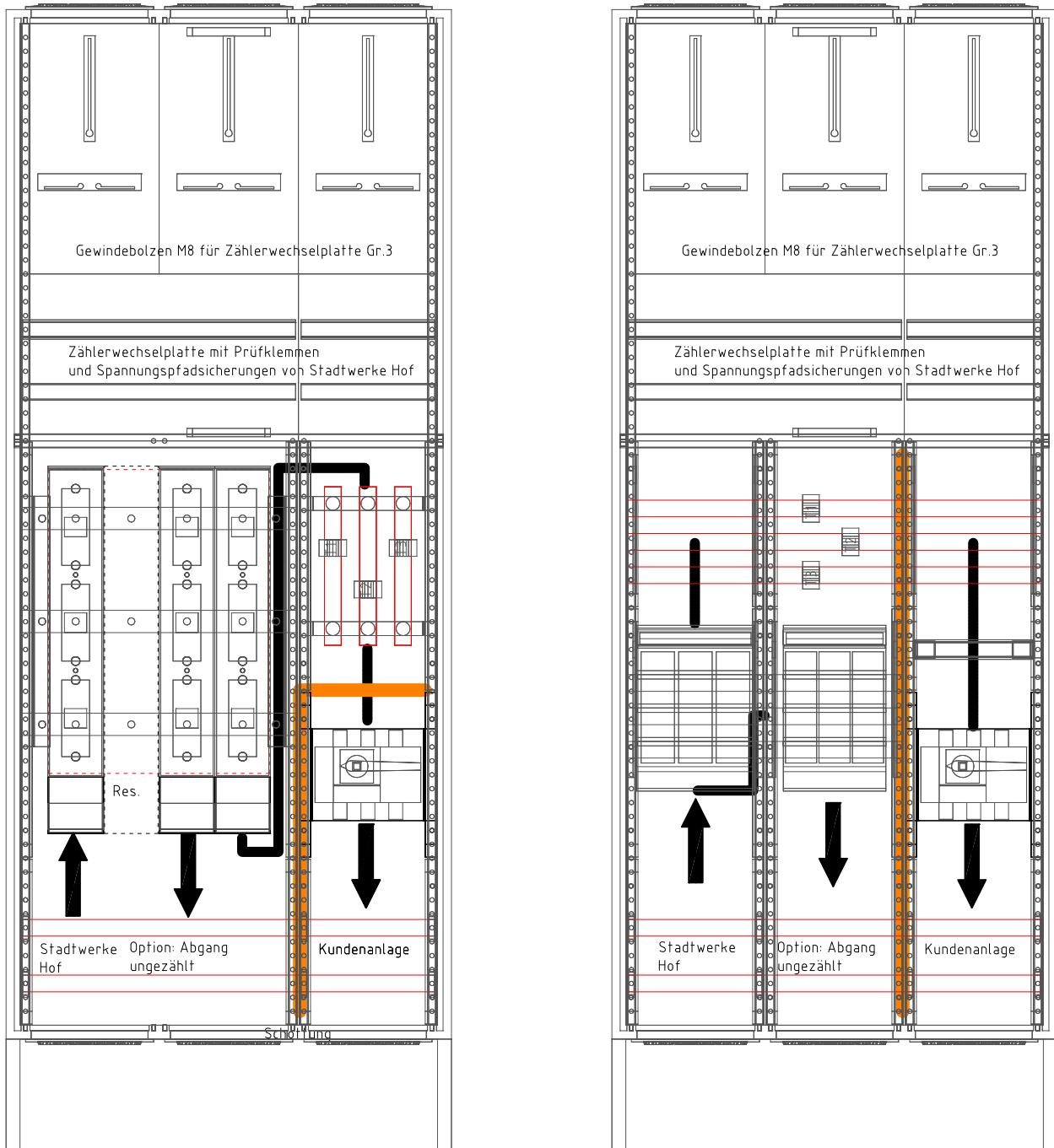
Zählerwechselplatte Gr.3, Prüfklemmen und Spannungspfad-Sicherungen werden von den Stadtwerken Hof geliefert und in Rechnung gestellt.
